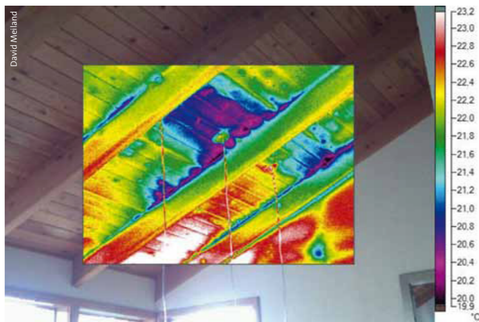
Esempi di thermal bypass in strutture a secco.
